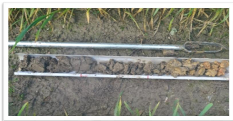
Photographie 1 : Exemple de carottage sur une profondeur de 120 cm
